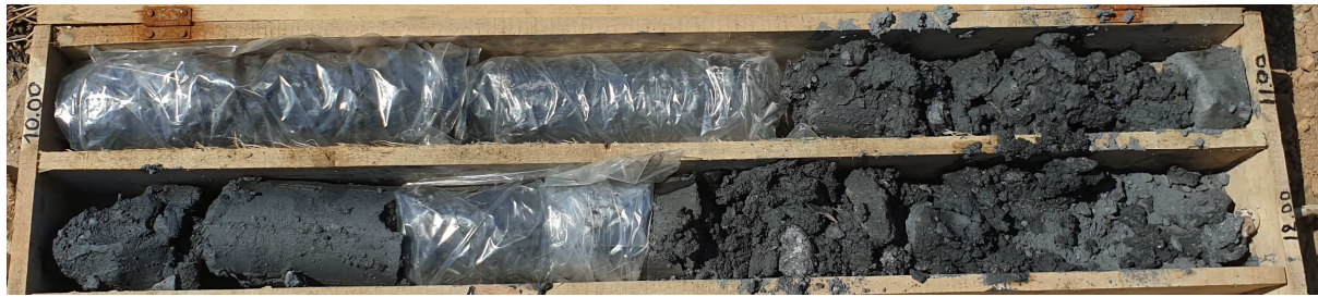
Εικόνα 4. Γεώτρηση Γ1, βάθος δειγματοληψίας από 10,00 έως 12,00m.
