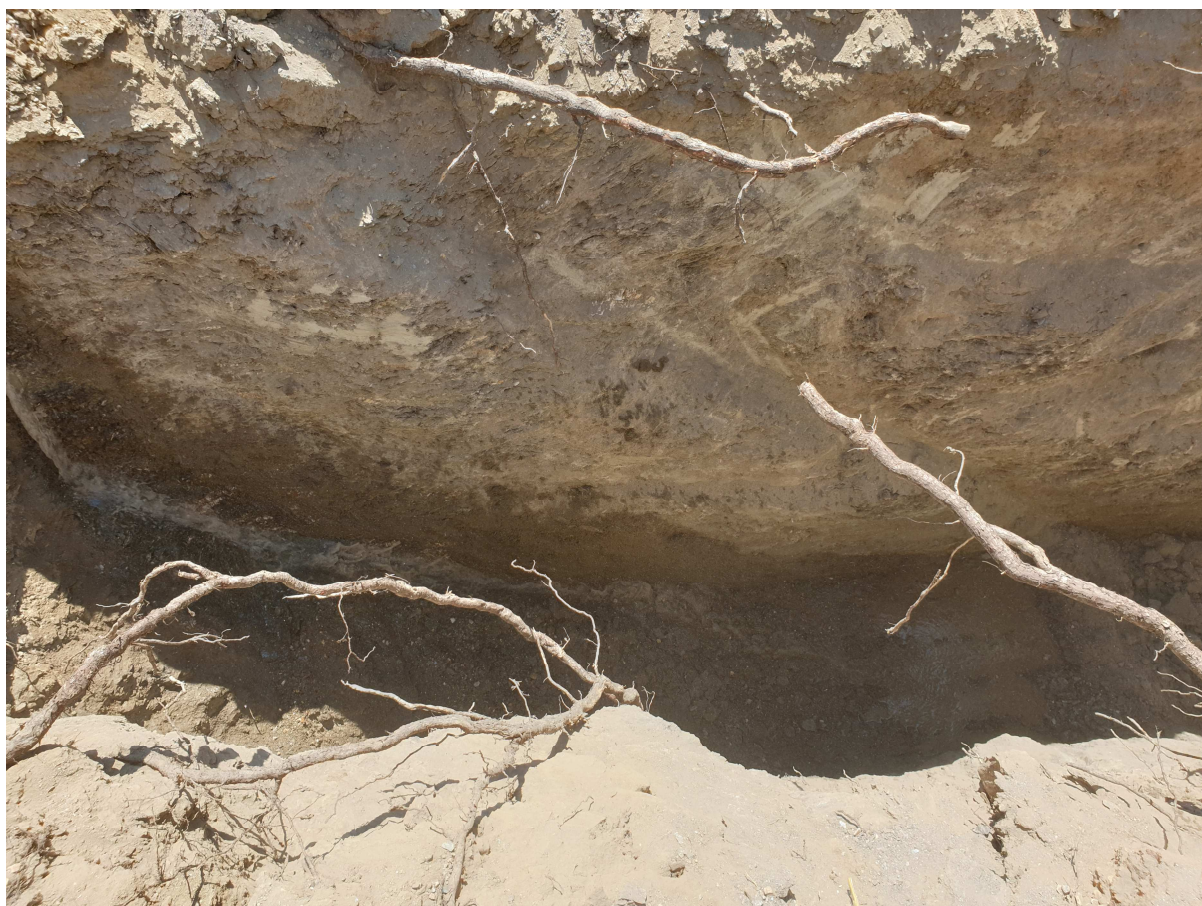
Εικόνα 6. Ερευνητικό φρεάτιο στη θέση αντλιοστασίου ΚΠ3, βάθους 4.00m.
