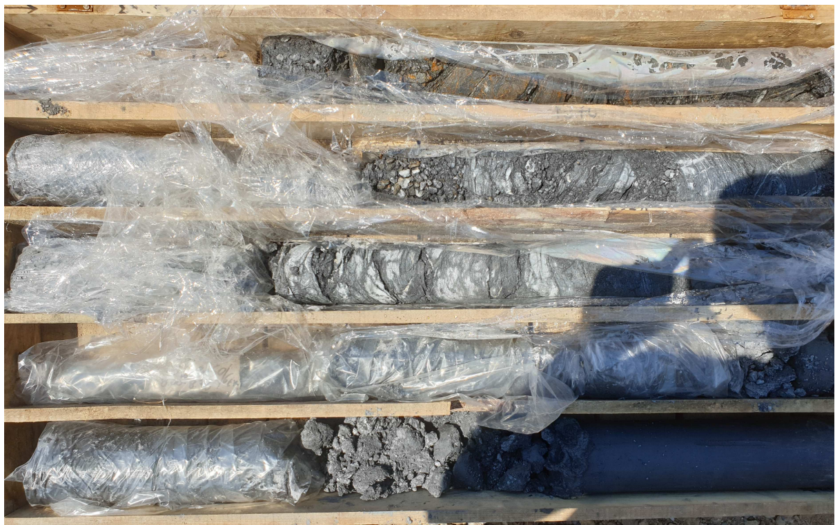
Εικόνα 3. Γεώτρηση Γ1, βάθος δειγματοληψίας από 5,00 έως 10,00m.
